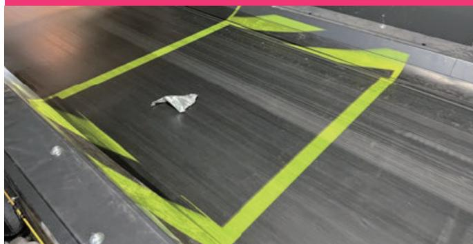
金属検出器によって検出された金属のエリアを表示すると同時に、音による警告も。
