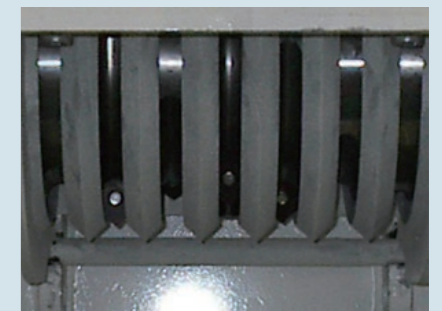
スリットスクリーン ビニール系の軟質プラを主体に破碎する場合に使用します。
