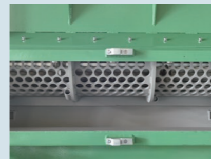
丸穴スクリーン 標準タイプのスクリーン ご指定頂いたサイズで製作します。 (φ20～φ80程度)
