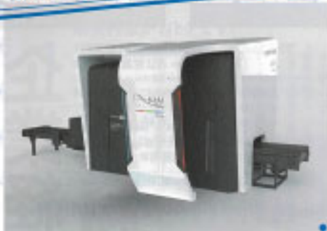
AI廃棄物選別支援システム ELENA エレナ AIが廃棄物の形状を認識し、3Dオブジェクトマッピングとして撮影
